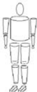
Figura 6. El modelo de Hanavan (1964) es un ejemplo de modelo a parámetro inercial.
