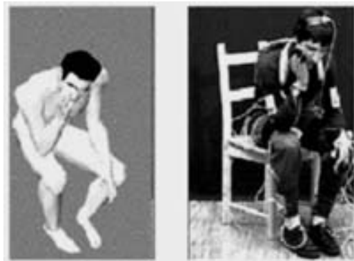
Figura 7. Modelo para animación virtual mediante la captura del movimiento humano.
