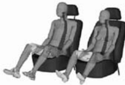
Figura 3. Maniqués antropométricos (hombre y mujer). Estos maniqués fueron utilizados para estudiar las lesiones de columna vertebral en accidentes automovilísticos.
